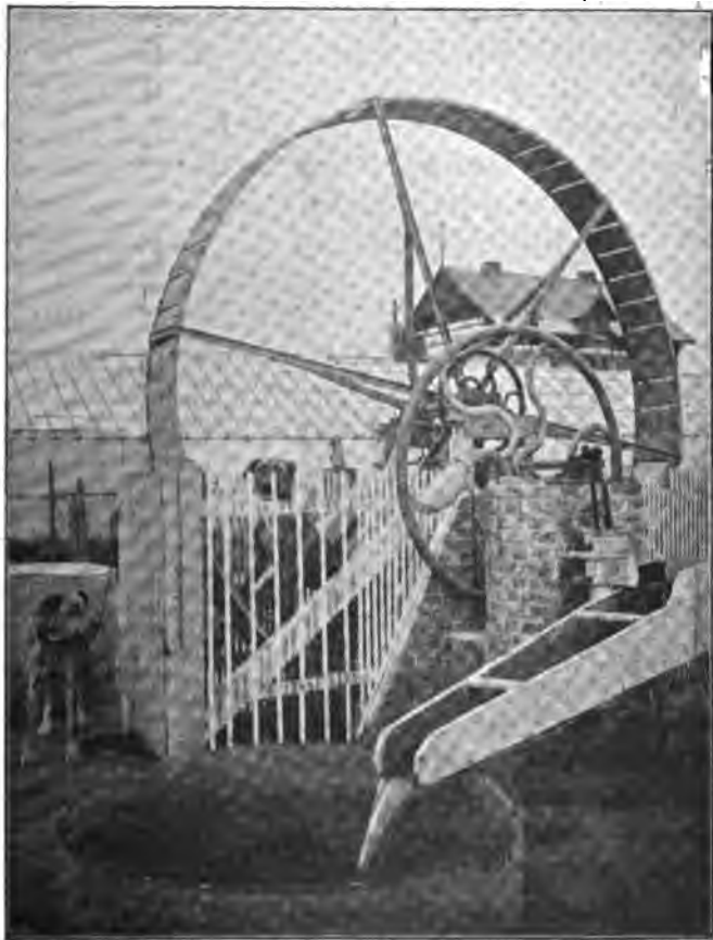
Fig. 15. — Chien employé comme moteur pour pomper de l'eau (D'après une photographie de M. A. BUYSSENS.)
